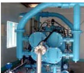
Фильтр для очистки поверхностной воды до качества питьевой (120 м 3 /час, 3 мкм)
