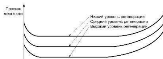
Рис. 2. Изменение проскока жесткости в процессе умягчения воды на катионитном фильтре для разных уровней регенерации смолы
