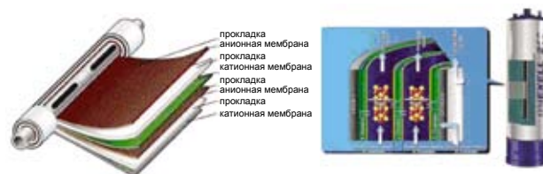
Рис. 2. Конструкция рулонного модуля электродеионизатора
